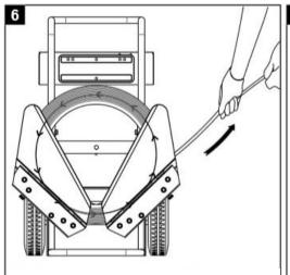
最初にバンドの先端に最も近い結び目を カットして、取り外します。 次に残りの結び目をすべて切断し、 ストラップを引き出して操作を開始します。
