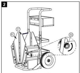
各サイドカウンターでNo.50(ナット)を 反時計回りに緩め、No.37(右調整プレート)と No.61(左調整プレート)を外側に調整します。
