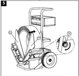
No.37(右調整プレート)とNo.61(左調整プレート)をバンドに向かって押し、時計回りに回転させ両サイドのNo.50(ナット)をしっかりと締めます。
