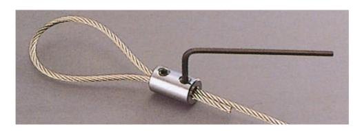
クリップにワイヤーロープを通して六角レンチ(-ドライバー)でしっかり締めます
