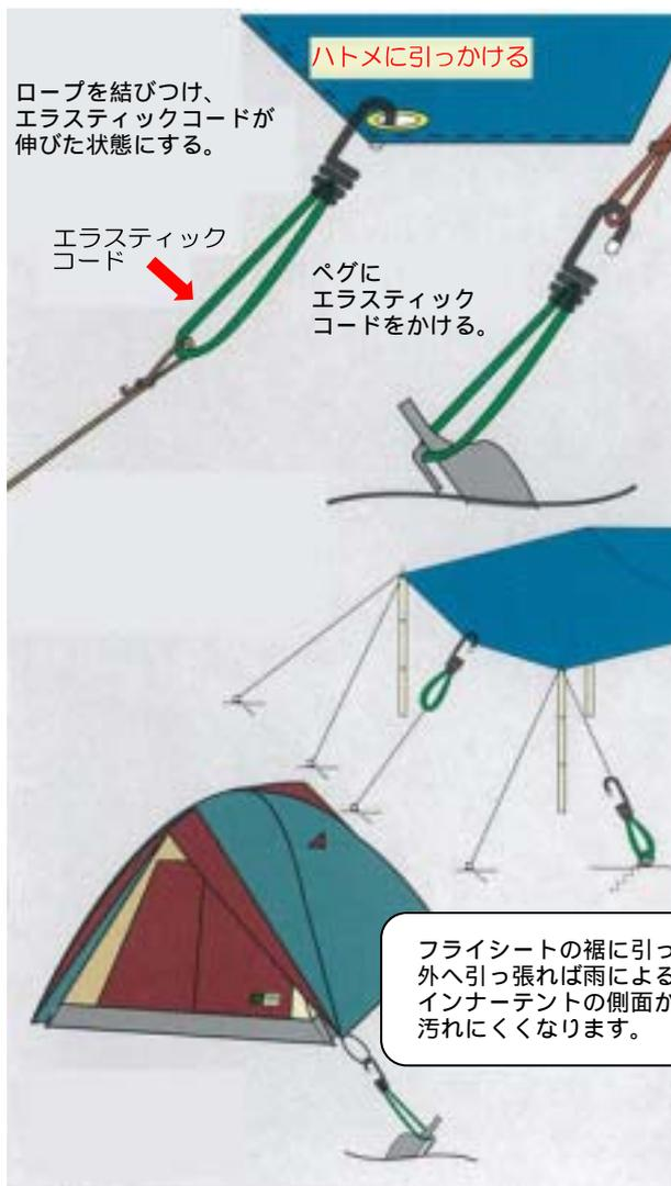
エラスティックコードが伸びた状態で使用してください。ロープの伸びによる、タープのたるみを防止します。
