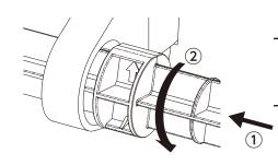
★ 細芯用軸芯を取付・取外 しする場合は、スパナ (8mm)を軸に掛け回す と簡単に固定できます。
