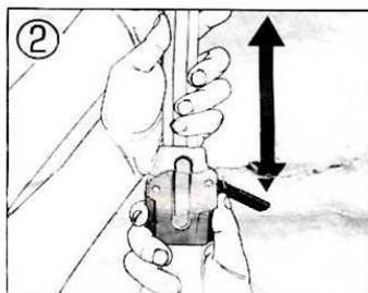
②ズームレバーを握ったままで、パイプを伸縮させます。連結位置の手前で一度止め、ズームレバーをはなし、ゆっくり動かして連結させてください。所定の位置での「カチッ」という音が連結の合図です。
