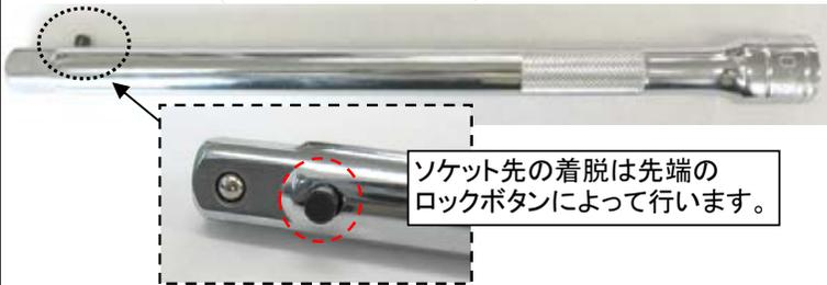
ソケット先の着脱は先端のロックボタンによって行います。
