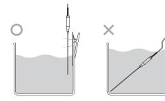
●センサコードを手のひらで押し付 けながら測定物に突き刺す。
