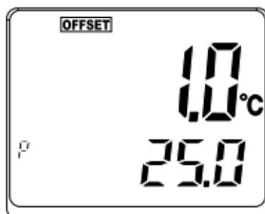
OFFSET機能中は、上段に温度差、下段に基準温度を表示します。
