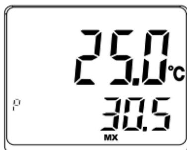
MAX/MIN機能中は、表示部上段に現在の測定温度、表示部下段に最高温度値または最低温度値を表示します。
