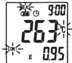
DIPスイッチをCONT.側(P.7「DIPスイッチの設定」参照)へ合わせた状態で(MEASURE)を押すと、液晶画面上に“CONT”が点灯され連続測定が開始します。(MEASURE)を離しても測定し続けます。
