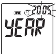
“TIME”が点滅し、その後、「YEAR」が点滅 → 「YEAR」が点灯 / 時計に西暦が点滅 → へと自動的に表示が切り替わります。
