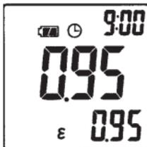
“EMS”が点滅し、その後、液晶画面上に現在設定の放射率が表示します(サブ画面には現在設定の放射率が表示)。
