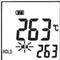
サブ表示に“CALL”と表示された後、画面上に“MEM”が点滅、サブ表示に **(▲/MEM./CAL.)** を押し始めた時に表示されていた温度指示値が点灯し記録されます。
