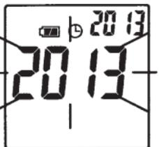
(▼/MAX/MIN) か (▲/MEM./CAL) を押して、時計に点滅表示している西暦を設定したい西暦に変更し (MEASURE) を押し決定してください。
