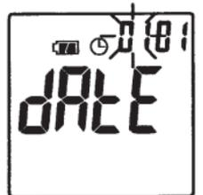
設定した西暦の点滅後、「date」が点滅 → 「date」が点灯 / 時計の左2桁（月）が点滅・右2桁（日）が点灯 → へと自動的に表示が切り替わります。
