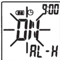
(▼/MAX/MIN)か(▲/MEM./CAL.) を押して設定 (ON)、解除 (OFF) を選択し、(MEASURE) を押し決定してください。
