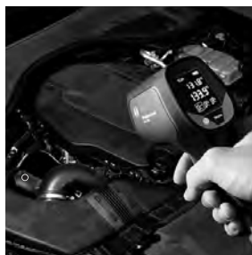
車両整備時の診断に。 ポイントごとに非接触で 温度の確認ができます。
