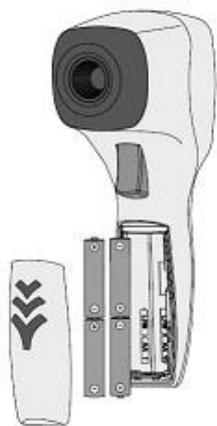
電池蓋を開けて、表示に従って電池を挿入して下さい。
