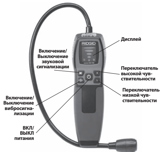
Рис. 2 – Детали прибора micro CD-100
