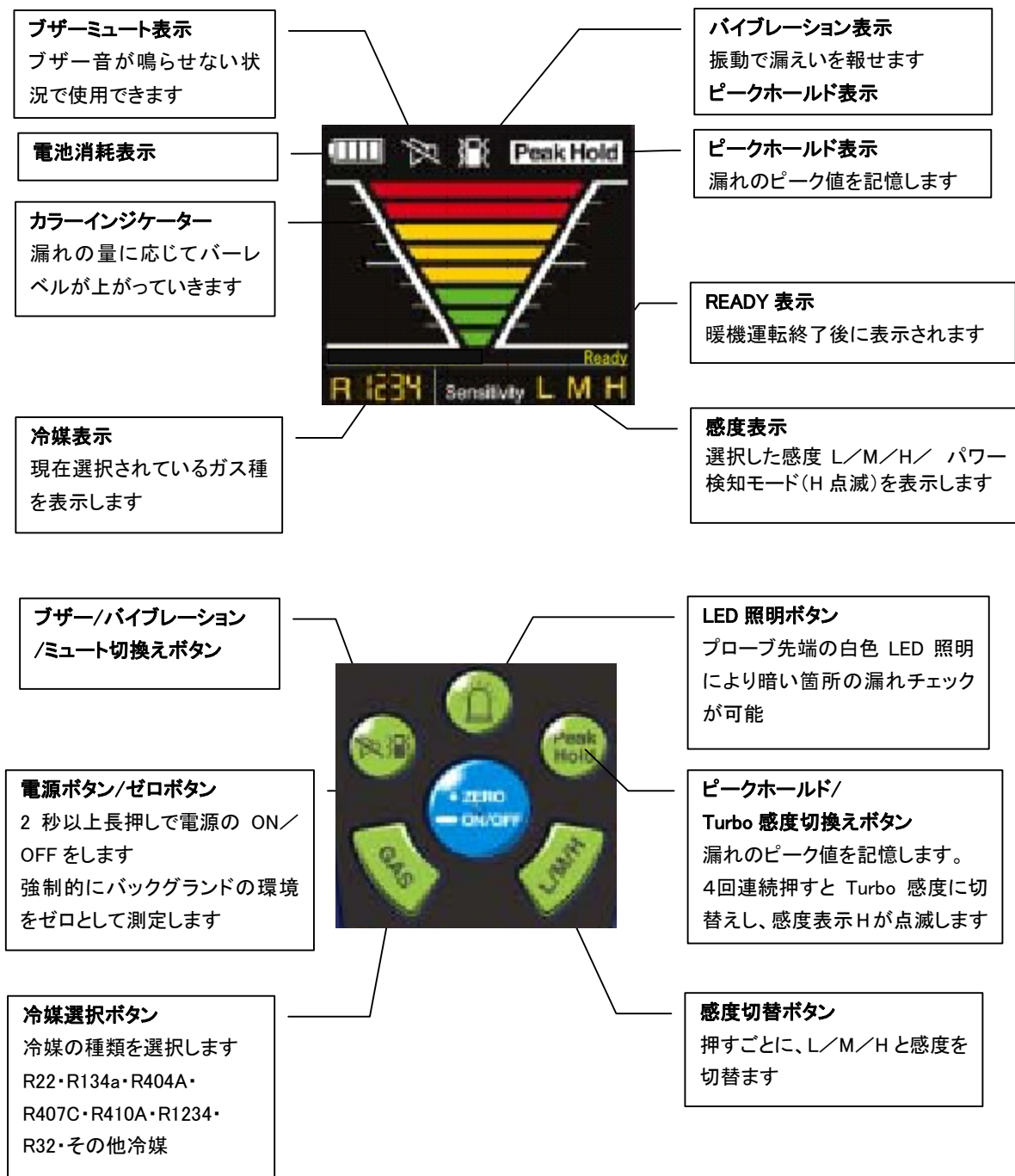
図3. 2 操作パネルとディスプレイの説明
