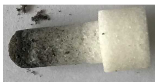
汚れフィルター
