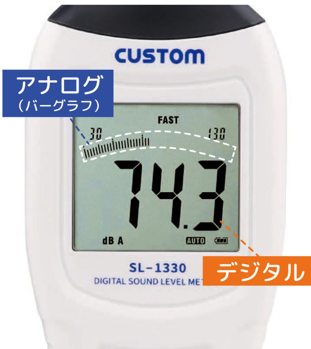
変化量が瞬時に認識できる「アナログ表示」（バーグラフ）と測定値を瞬時に確認できる「デジタル表示」の2種類に対応。
