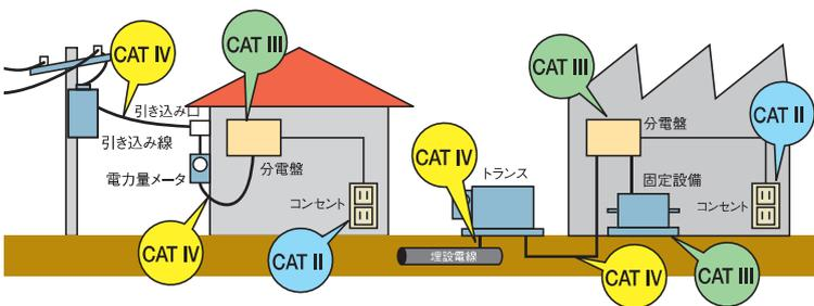
数値の大きいカテゴリは、より高い瞬時的なエネルギーのある電気環境を示します。そのため、CAT IIIで設計された測定器はCAT IIで設計されたものより高い瞬時エネルギーに耐えることができます。
