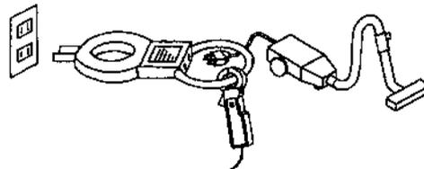
2. 測定精度は、各プローブの精度を本体の精度に加算したものになります。
