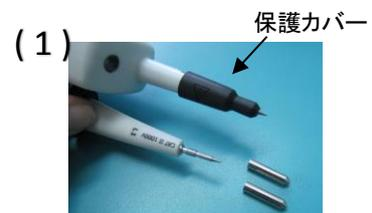
本体のテストプローブ(+)と、片方のテストプローブ(-)を、テストする対象物(ライン、ソケットなど)に接触させる。(2)参照)
