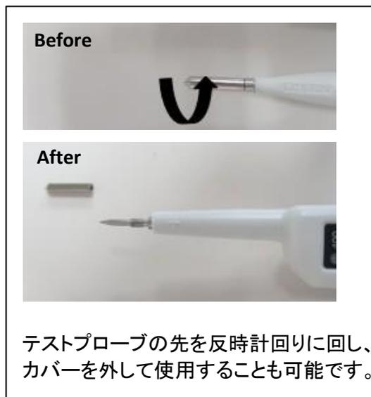
テストプローブの先を反時計回りに回し、カバーを外して使用することも可能です。
