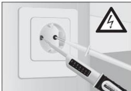
(+)テストプローブと(-)テストプローブを両手に持ち、ラインやソケットなどにテストプローブを差し込み測定します。電圧がある場合はLEDが点灯します。
