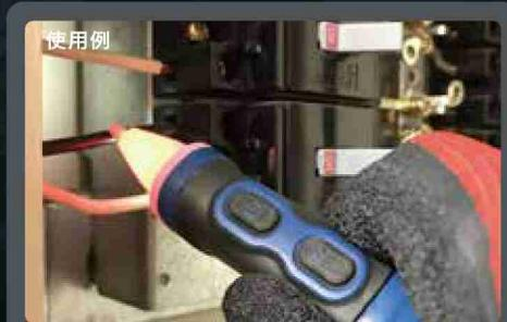
被覆線にテストプローブの先端を接触させます。
