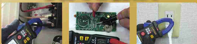
① クランプメータ ② テスター ③ 検電器
