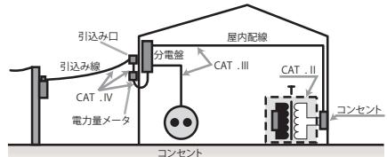
測定カテゴリの電圧は一般的に対地電圧になります。Y 結線 480 V や非接地  $\Delta$  結線 480 V の 2 次側は CAT. III 300 V 内となります。
