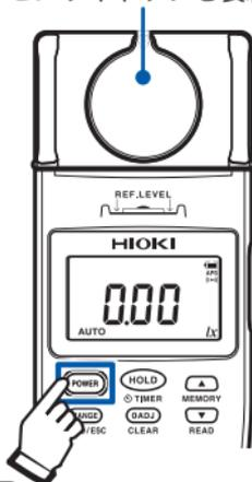
6 測定が終了したら、センサキャップを装着して電源を切る
