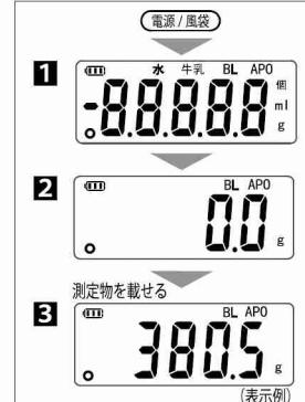
3 選択した個数の測定物を計量台の中央に載せ、「設定」ボタンを押すと質量の登録が完了します。測定物を取り除き「0個」が表示されたら測定可能です。表示が「0個」にならない場合は「電源/風袋」ボタンを押してください。
