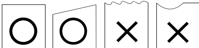
3. プリンタ用紙の先端を印字ユニットの挿入口に差し込みます。
