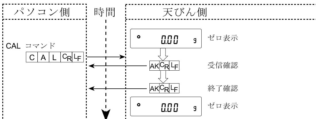
CAL コマンドの例 (FX-i シリーズ/FX-iWP シリーズ 外部分銅によるキャリブレーション)
