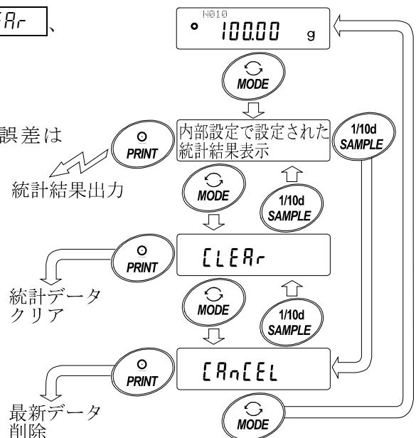
⑥ 統計結果表示中に、**PRINT** キーを押すと、統計結果が出力されます。
