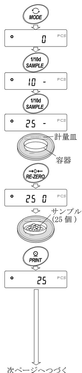
※ 個数計量を精度よく行う場合は、サンプルの単位質量(1個の重さ)は、少なくとも天びん最小表示の10倍以上の物を対象とすることをお勧めします。例えば最小表示0.01gの機種をお使いの場合、お勧めするサンプルの単位質量は0.1g以上となります。
