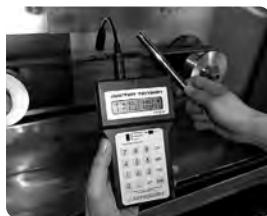
ベルトスパンの中央、上部にセンサマイク面を平行に向けて約10mmの位置に固定します。
