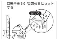
回転子を回して図のように本体の角度 測定目盛の60 と合わせてください。
