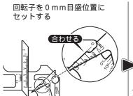
回転子を回し、図のように本体のアン ダーカット測定目盛の 0 mmに合わせ てください。
