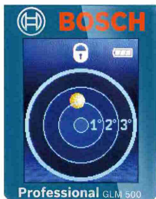
水準器として使用した時の表示画面。傾斜が3°以上ある時は、気泡が赤く点灯します。
