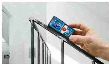
傾斜計や水準器としても使用することができます。また、距離と角度を同時計測できるのでピタゴラス測定も簡単にできます。
