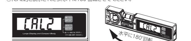
⑤「ゼロセット/校正ボタン」を押すと「CAL2」が点滅し、再度校正が始まります。
