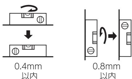
このとき気泡の移動量が水平気泡管で0.4mm以内、垂直気泡管で0.8mm以内であれば精度の範囲内です。
