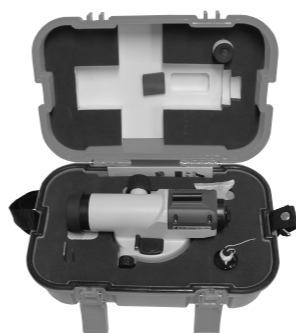
オートレベル ケース 取扱説明書 下げ振り 矯正針 六角レンチ 乾燥剤
