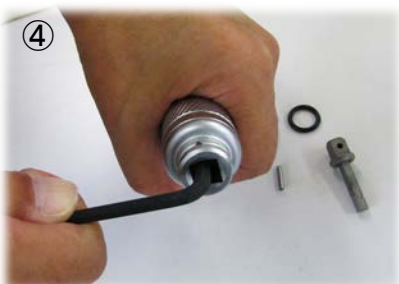
④付属の六角棒レンチを 保護ねじに差し込み、外します。
