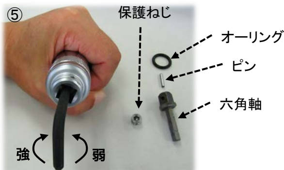
⑤六角棒レンチで時計方向に回すとトルクが強まり、 反時計方向に回すとトルクが弱まります。
