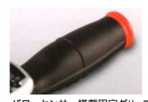
パワーセンサー搭載固定グリップ 複数のセンサがグリップにかかる操作荷重を正確に感知し分析。 作業姿勢や習熟度にかかわらず、より精度の高いトルク測定が 可能。
