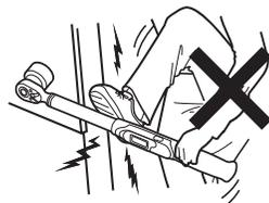
正しいトルクが出ません。レンチの破損、ボルトからの外れ、けがの原因になります。
