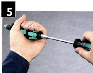
5. トルク値校正時はハンドル上部のキャップを外すと校正用のナットがあるので、トルク値調整キット(EA723VJ-21:別売)で調整してください。
