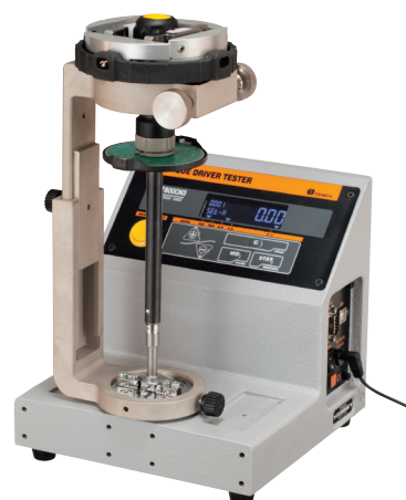
TDT3 と別売品の LTA を用いた FTD の校正例
