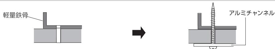
ドリルで $\phi 3.4$ の下穴をあけます。(既存のビスが付いていた時は、これを利用も可) 同封のビス( $\phi 4.0$ )をドライバーでねじ込みます。
