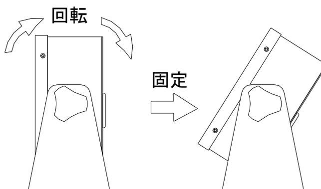
※ノブネジを回すことでノブネジを外すことができます。そのときに本体が固定台より外れますので、本体の落下にはご注意ください。また、落下させた場合にその衝撃によって故障する恐れがあります。取り扱いには十分ご注意ください。
