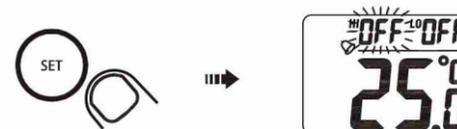
② HOLD・アップボタン、MAX/MIN・ダウンボタンを押して上限値を設定します。このとき、HOLD・アップボタン、MAX/MIN・ダウンボタンを長押しすると数字が高速で更新され、設定時間を短縮できます。電源・CALボタンを押すと“OFF”(上限値設定なし)にすることができます。
