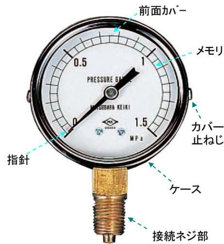
※ ブルドン管とは断面が楕円形の管を円形状に曲げて一端を固定し、他端をとじたものです。保安用や工程管理用などに広く用いられています。
