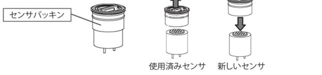
⑥ センサのピンの位置(非対称)を合わせて、センサの底面がケースの基板に当たるまで押し込みます。
