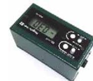
② 【180° ひっくり返し：表示 0.30 mm/m】 【 1/2コール：表示 0.15 mm/m】
