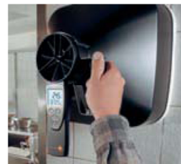
testo 417 ベンチレータ用 ファンネル使用例
