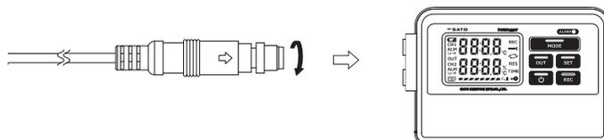
注意：センサチャンネル1（CH1）からセンサを接続してください。チャンネル1（CH1）未使用とし、チャンネル2（CH2）を使用した場合、計測はおこないますが、記憶は開始できません。
