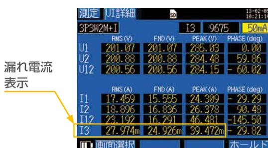
基本波実効値を確認することで、50/60Hz 成分の漏れ電流も確認できます。
