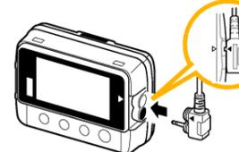
本体の▷マークとセンサの◀マークをあわせて奥まで差し込む。(接続ケーブルの突起が本体の切り欠き部に入るようにします。)
