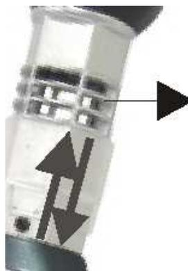
センサ保護カバーを下にスライドし、センサを露出してください。
