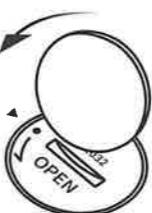
② 電池【CR2032】の+側を上にして、矢印の方向から端子をつぶさないように横から当てるようにして入れます。
